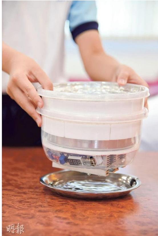
食物盒下方的盤子要放冰水，才能將熱能化作電能，做到溫差發電的效果。
