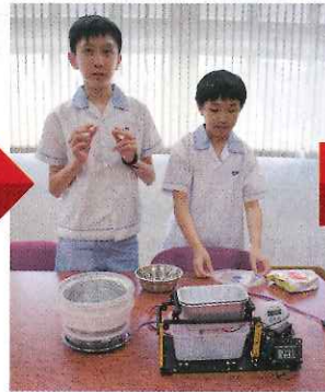
● 中間是膠盤組合層。面部有錫紙包圍的膠盤，底部有電腦散熱組件，以及穩電器、顯示電量燈，和輸出電量的裝置。
