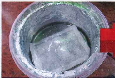
● 用金屬盤盛載頂層的煮食食材，並於石灰層加入水，化學作用立刻開始產生。
