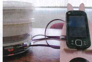
● 加蓋讓熱力得以更持久，當電力多於充電所需時，會藉由顯示燈消耗電力。
